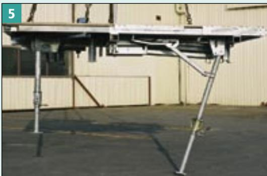
5 Déplier et vérifier le verrouillage du pied côté échelle.
