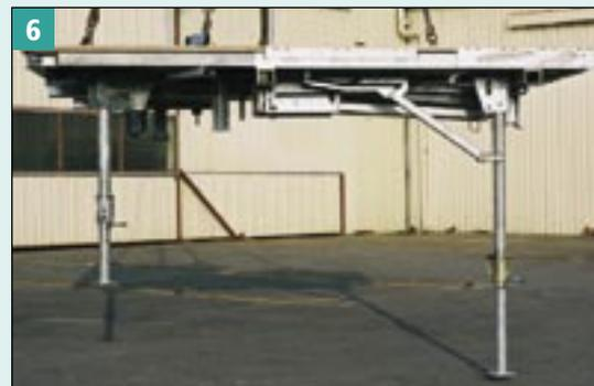
6 PCE avec grand pied verrouillé prêt à l'emploi. Mise en place de l'échelle et réglage des pieds après positionnement dans la cage d'escalier.
